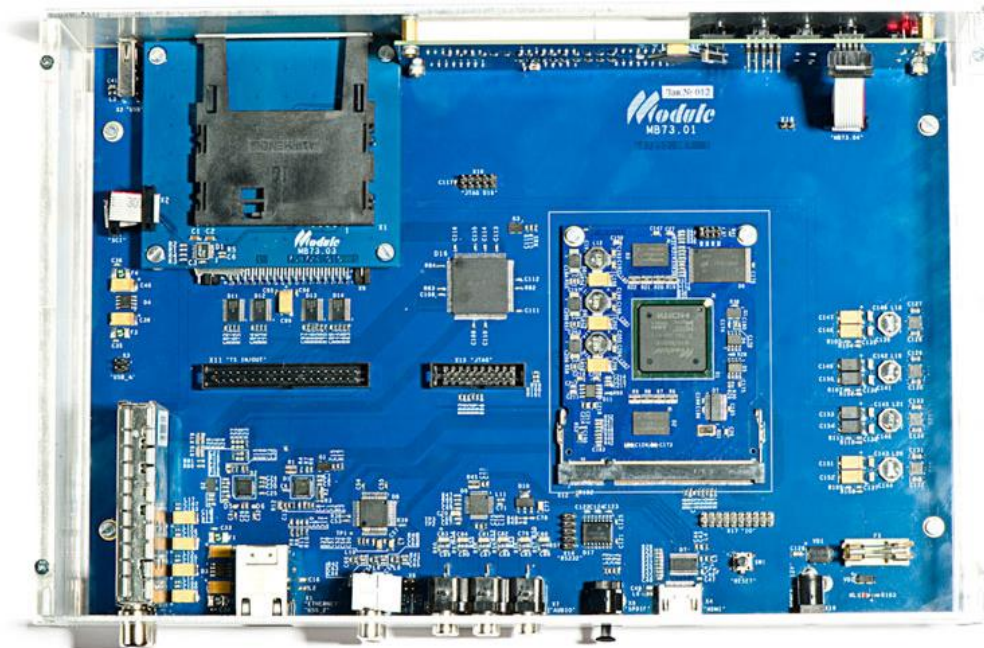
Рис. 4 Референсный цифровой телевизионный приемник Цифровая телевизионная приставка на базе СБИС К1879ХБ1Я
