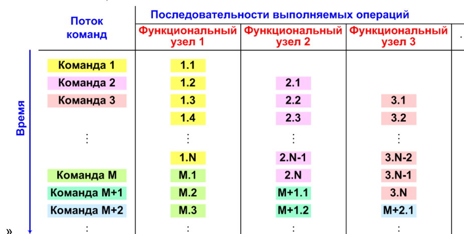
Рисунок 1.8 - Векторно-конвейерная организация вычислений (динамический VLIW)
