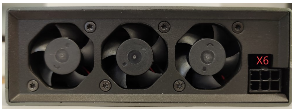
Рисунок 2.4 – Соединитель дополнительного питания X6 модуля NM Quad
