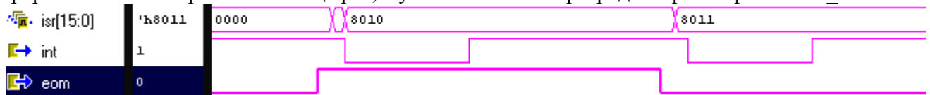
Рисунок А.2.1 - Формирование прерывания scw_e
