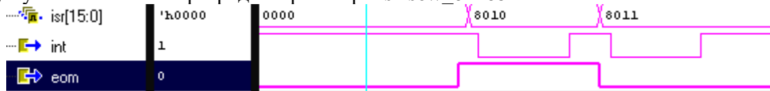
Рисунок А.3.1 - Формирование прерывания scw_e
