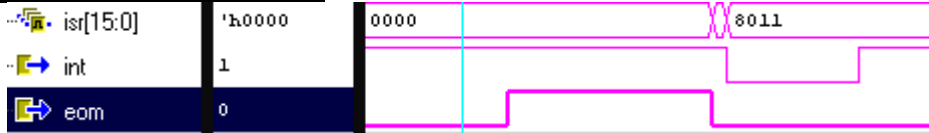
Рисунок А.3.2- Формирование прерывания scw_e
