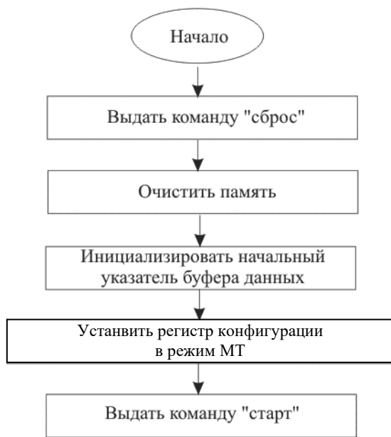
Рисунок 8.1 – Инициализация монитора слов
