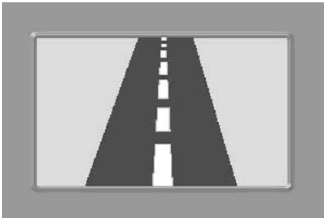
Рисунок 2.1 - Изображение дороги, соответствующее рекомендуемому положению камеры
