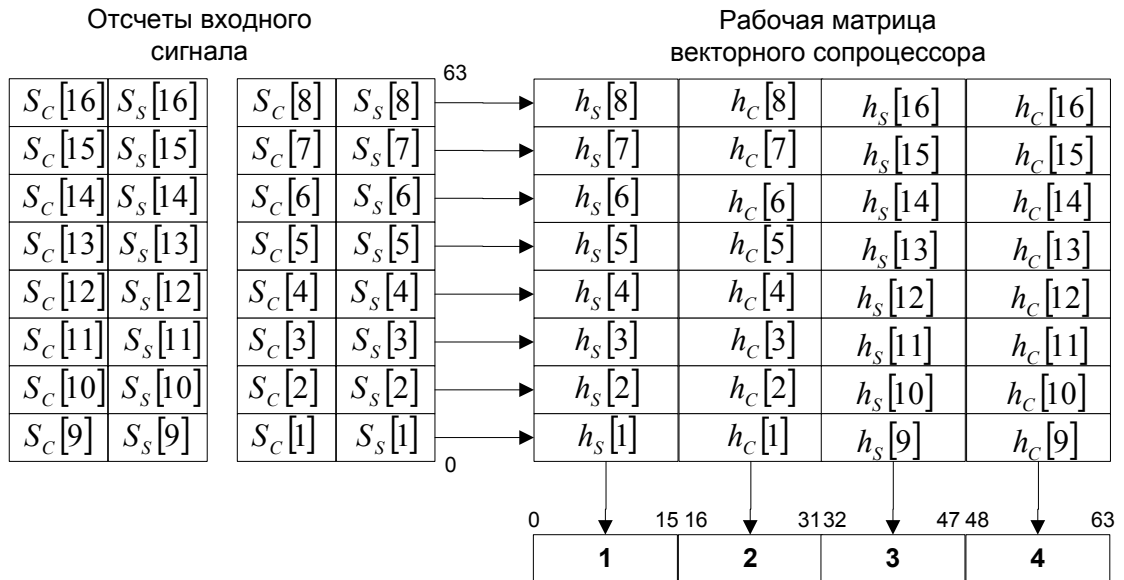
Рисунок 6. Схема организации вычислений при синтезе КИХ фильтра 16 порядка.
