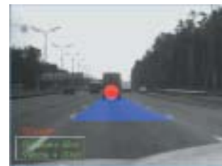
Рис. 10. Система обнаружения препятствий для предотвращения дорожно-транспортных происшествий
