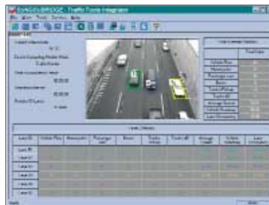
Bild 6: Der Traffic Monitor von RC Module ist ein "Stand Alone Real Time System zur Straßenüberwachung und Darstellung der Verkehrscharakteristik."
