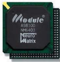
Рис. 5. Процессор цифровой обработки сигналов Л1879ВМ1 (NM6403)
