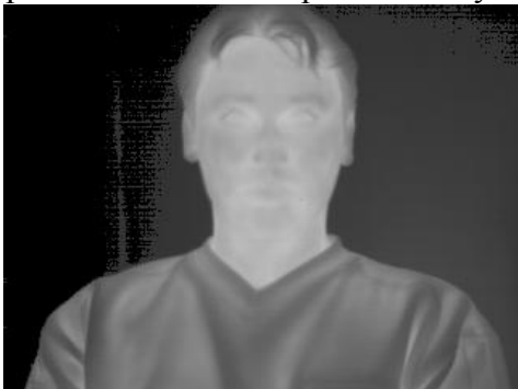
Рис. 3. Пример обработанного изображения по методу двухточечной коррекции без применения процедуры контрастирования
