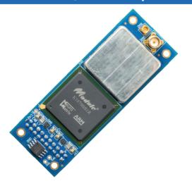
Модуль MC149.03— навигационный приёмник абсолютных измерений, обрабатывающий сигналы глобальных навигационных систем ГЛОНАСС и GPS в диапазоне L1.
