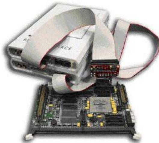
**Рисунок 11 – Комплект модулей трассировки и отладки RealView ICE и RealView Trace**
