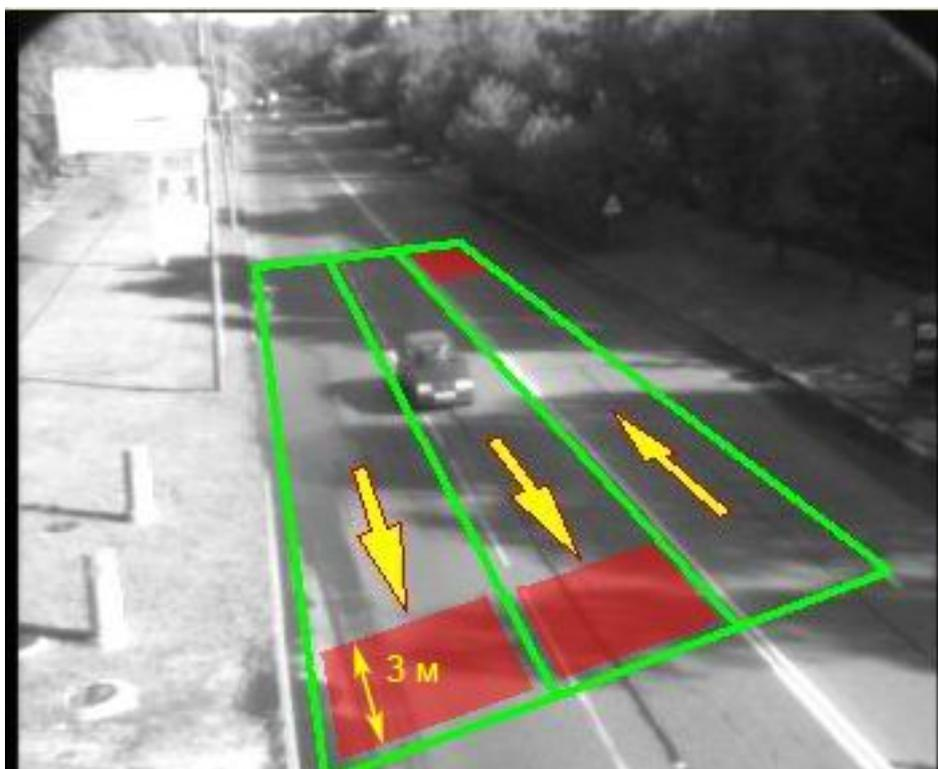
**Рисунок 4.2 - Области измерения загрузки**
