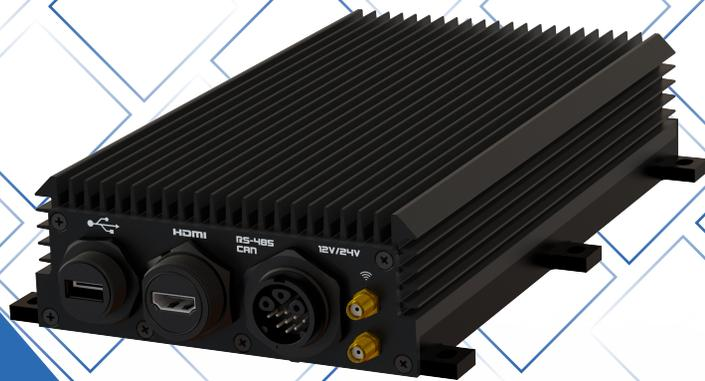
Пассивная система охлаждения
