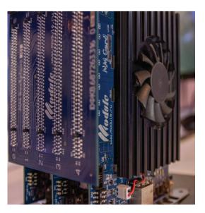
Специальная коммутационная плата NM BackPlane (аналог AMD CrossFireX и Nvidia SLI) позволяет использовать параллельно до 5 модулей NM Card для решения общей задачи.
