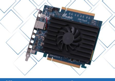
Вычислительный модуль на основе многоядерного DSP-процессора на базе оригинальной архитектуры NeuroMatrixCore 4 с управляющим RISC-процессором ARM Cortex A5 в форм-факторе PCI-е.
