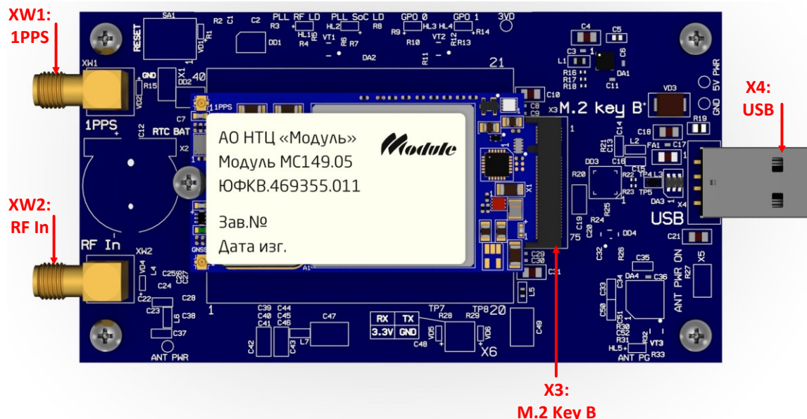
Рисунок 1.9 – Интерфейсы и органы управления NVMXEvKit в исполнении ЮФКВ.469335.009-04
